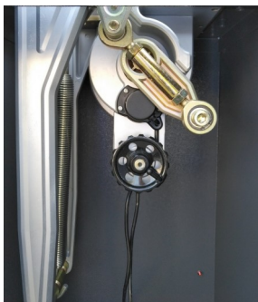
Pohon závory s BLDC motorem, převodovkou a klikovým mechanismem
